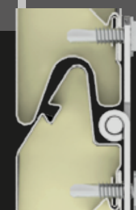
Instalación de bisagras
